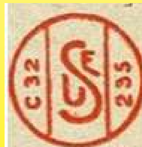
1957 Marcatura USE stampata con il numero standard (C32) e il numero di identificazione del produttore (295)
